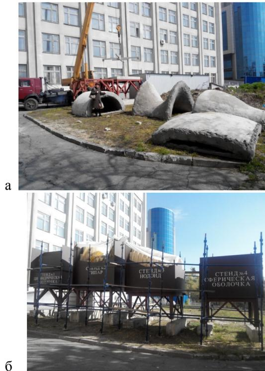
Рис. 17. Криволинейные железобетонные оболочки: а – установка оболочек для проведения их испытания; б – испытание оболочек нагружением столбом воды
