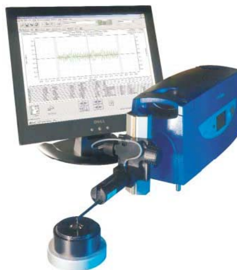
Рис. 3. Прибор для измерения шероховатости Английской фирмы Taylor Hobson
