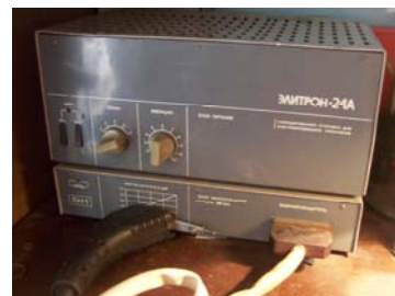
Рис. 1. Установка электроискрового легирования «Элитрон-24А»
