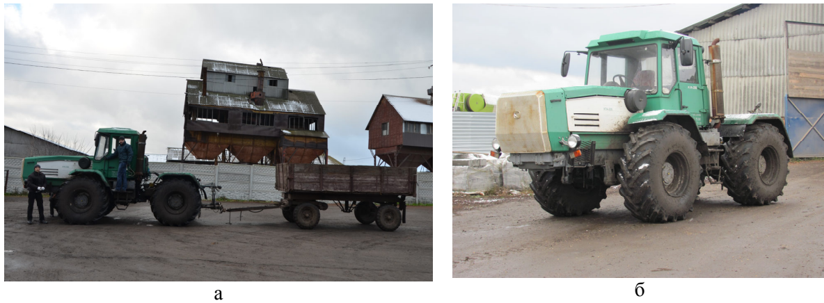
Рис. 1. Объекты для проведения экспериментальных исследований: а – тракторный поезд с двухосным прицепом (ХТА-200 «Слобожанец» + 2ПТС-4); б – шарнирно-сочлененный колесный трактор с номинальным тяговым усилием 35 кН ХТА-200 «Слобожанец»
