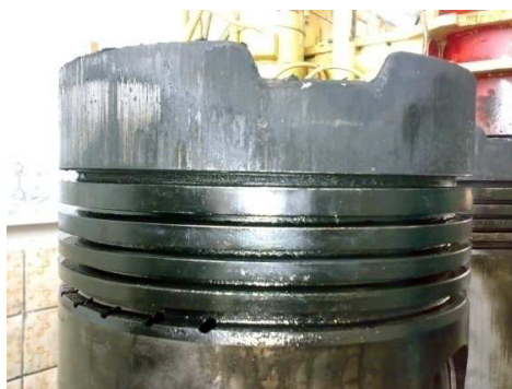
Рис. 5. Серийный поршень дизеля тепловоза ЧМЭ-3 №6835 после наработки 46512 моточасов
