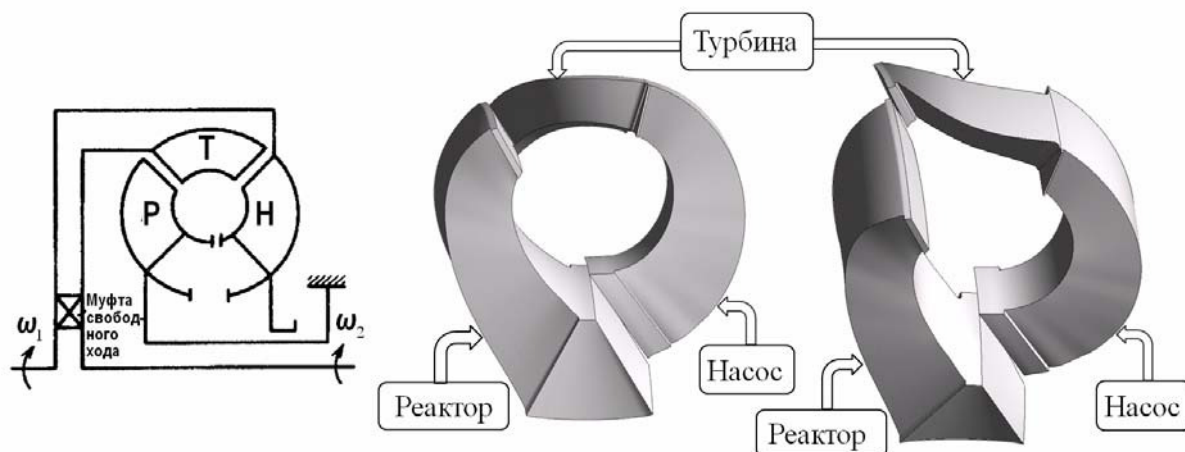
Рис. 2. Круг циркуляции гидротрансформатора У358011Д
