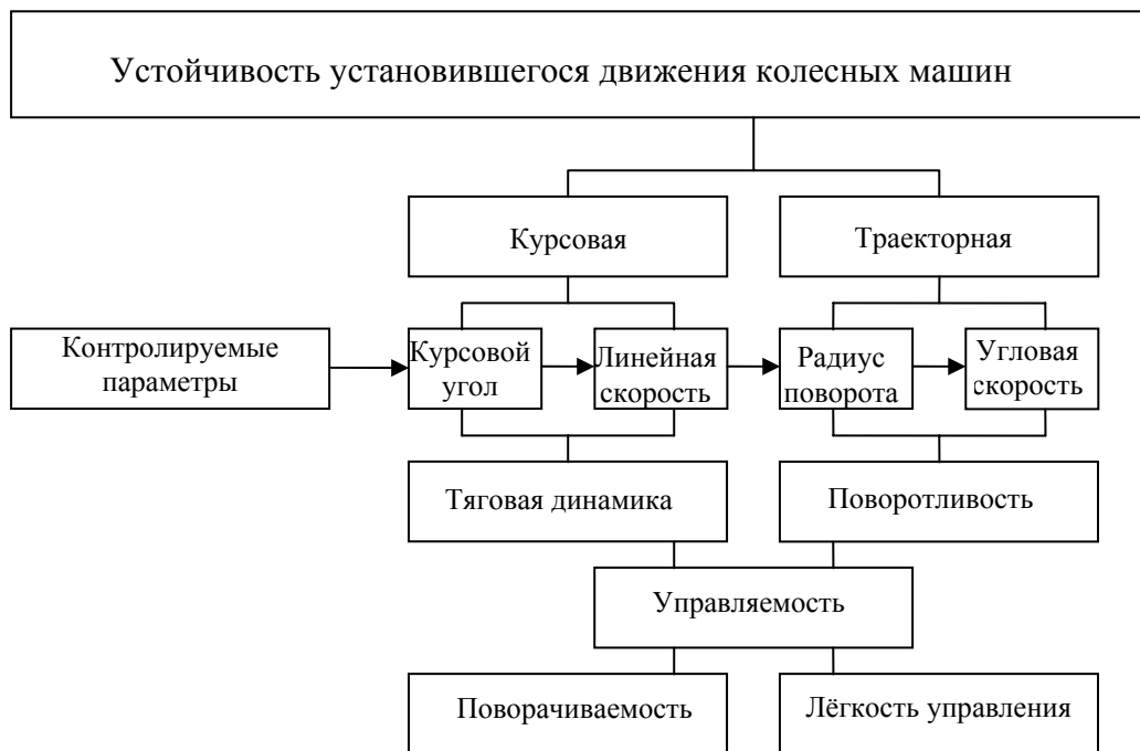
Рис. 1. Структура свойств устойчивости установившегося движения колесных машин
