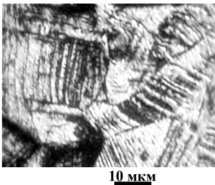
Рис. 1. Структура мартенситу деформації сталі 12X18H9
