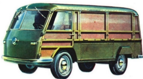
Рис. 11. Електромобілі НАМІ ЛАЗ вантажопідйомністю: а – 0,5 т; б – 1,5 т
