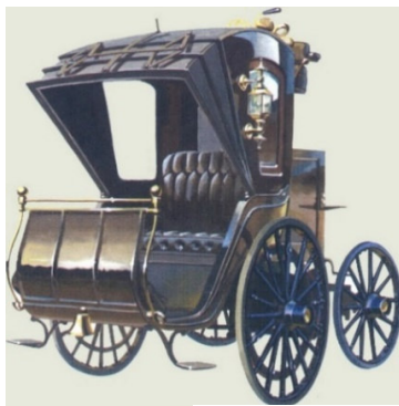
Рис. 7. Перші російські електромобілі: а – легковий 2-місний електрокеб; б – 15-місний електроомнібус
