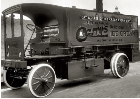
Рис. 9. Електромобіль, вантажівка-рефрижератор чиказької фірми Walker для транспортування морозива, 1920 р.
