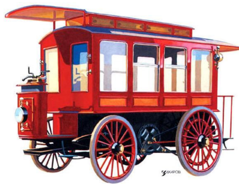
Рис. 7. Перші російські електромобілі: а – легковий 2-місний електрокеб; б – 15-місний електроомнібус
