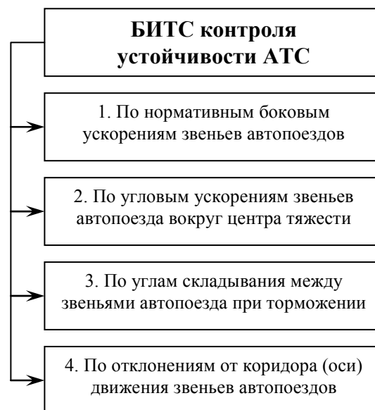
Рис. 3 Классификация БИТС контроля устойчивости АТС при торможении
