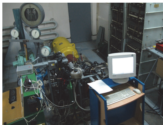
Рис. 1. Экспериментальный стенд с малолитражным автомобильным биогазовым ДВС
