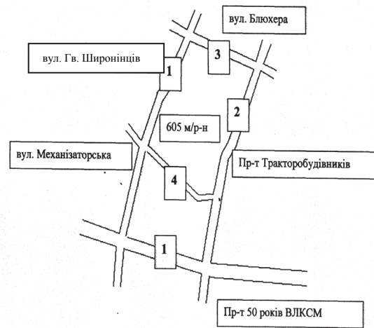
Рис. 3. Карта забруднення оксидом вуглецю вулично-дорожньої мережі 605 м/р-ну м. Харкова: 1 – 3,0–5,0 ГДК мр ; 2 – 2,0–4,0 ГДК мр ; 3 – 1,5–2,0 ГДК мр ; 4 – 0,5 ГДК мр
