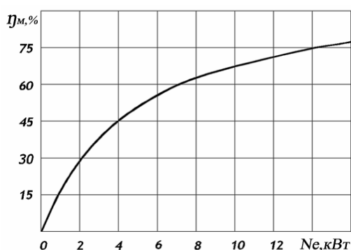
Рис. 1. Зависимость относительного уменьшения КПД ДВС от мощности нагрузки для легковых автомобилей
