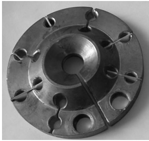
Рис. 6. Одновитковый индуктор с внутренним отверстием конического профиля
