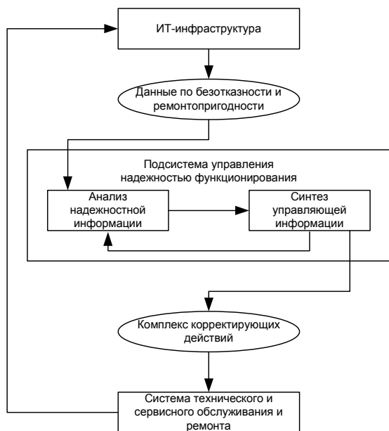
Рис. 2. Схема управления надежностью
