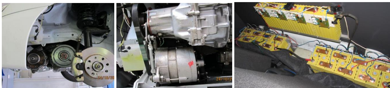
Рисунок 18 – Привод тягового електричного двигуна та розміщення ТАБ
