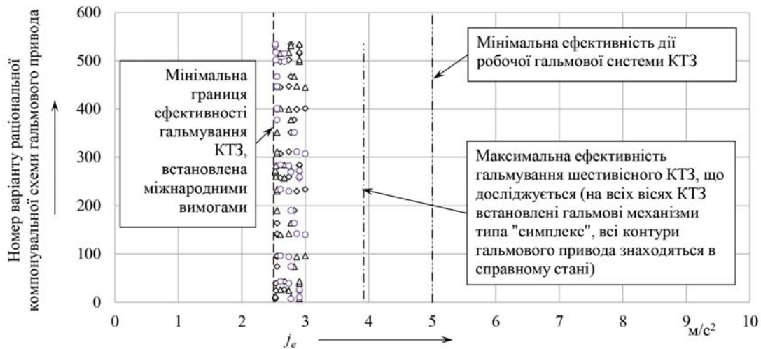
Рисунок 9 – Ефективність гальмування шестивісного КТЗ ( V_n = 30,5 м/с) з триконтурним гальмовим приводом: \diamond – працює другий та третій контур гальмового привода; \Delta – працює перший та третій контур гальмового привода; \circ – працює перший та другий контур гальмового привода
