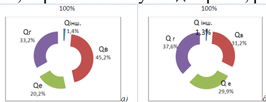
Рис. 2 Тепловий баланс двигуна
