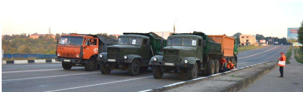
Рисунок 1 - Установка испытательной нагрузки по схеме 1
