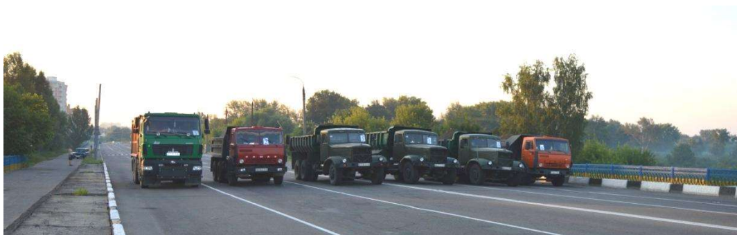
Рисунок 2 - Установка испытательной нагрузки по схеме 2
