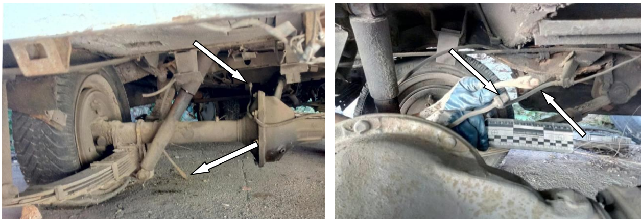
Рисунок 1, 2 – Загальний вигляд пошкодження гальмівного трубопроводу автомобіля РАФ
