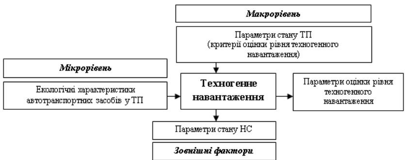
Рис. 1 – Формалізована схема розрахунку екологічних характеристик транспортних потоків
