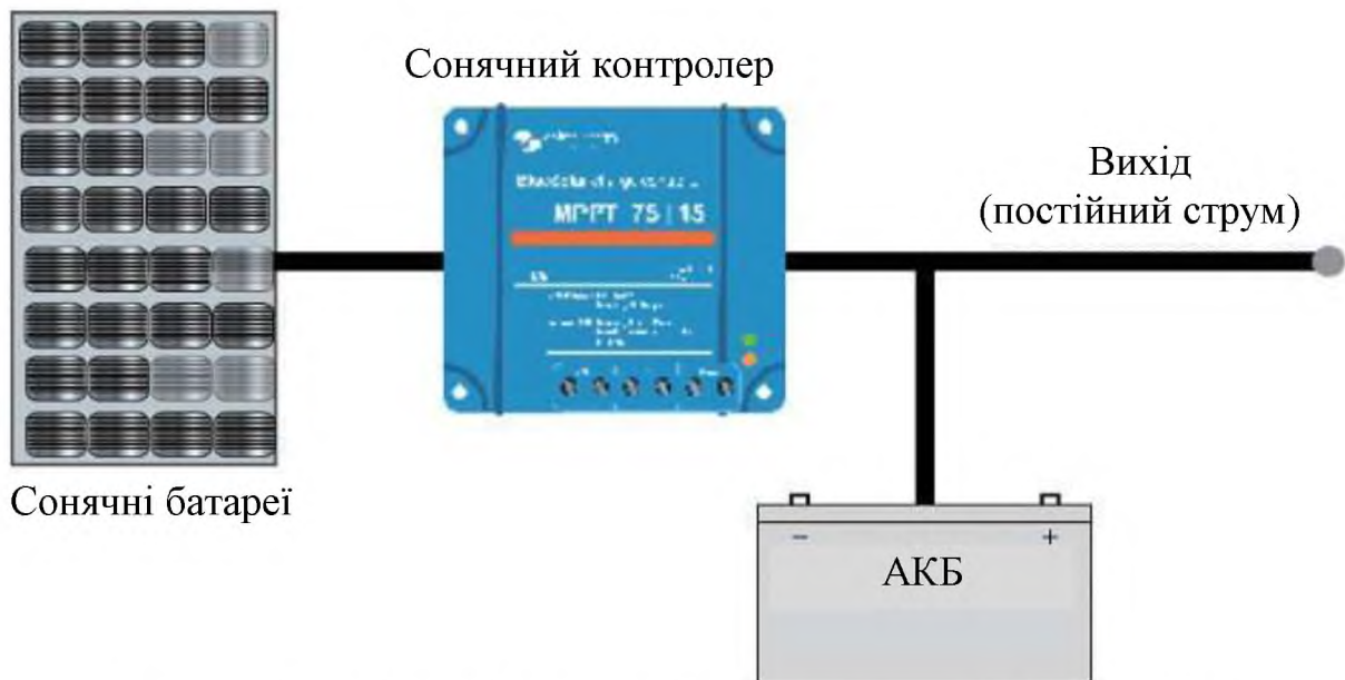
Рисунок 1 – Схема СЕС автономного типу постійного струму
