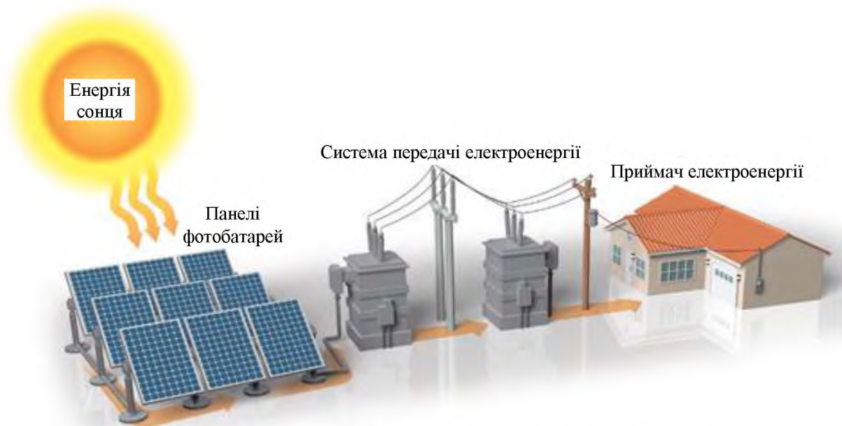
Рисунок 1.8 – Схема СЕС, що використовують фотобатарей
