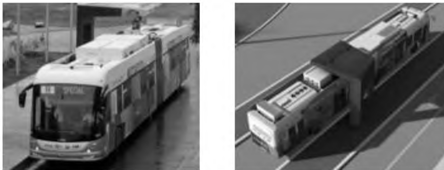
Рис. 5. Електробус на ультраконденсаторах компанії China South Locomotive & Rolling Stock Corporation
