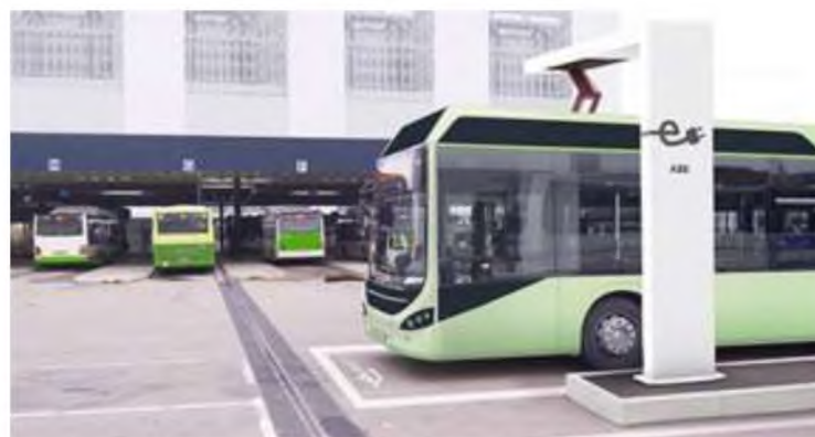
Рисунок 2.3 – Швидкий заряд електробусів (Люксембург)
