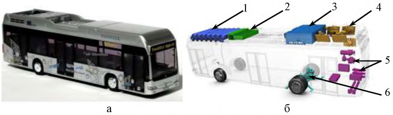
а - зовнішній вид; б – конструкція; 1 - балони H_2 ; 2 - АКБ; 3 – система управління; 4 - система охолодження; 5 - допоміжні компоненти; 6 – електропривод Рисунок 2.4 – Електробус Citaro Fuel Cell Hybrid
