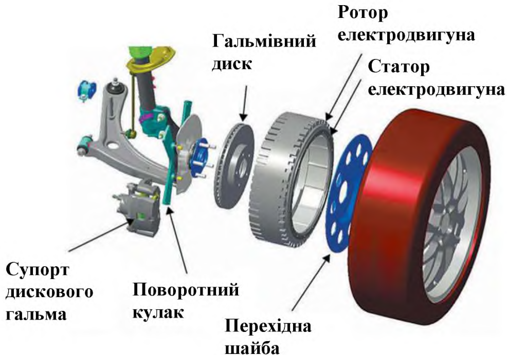
Рис. 1 - Схема безредукторного двигуна для автотранспорту
