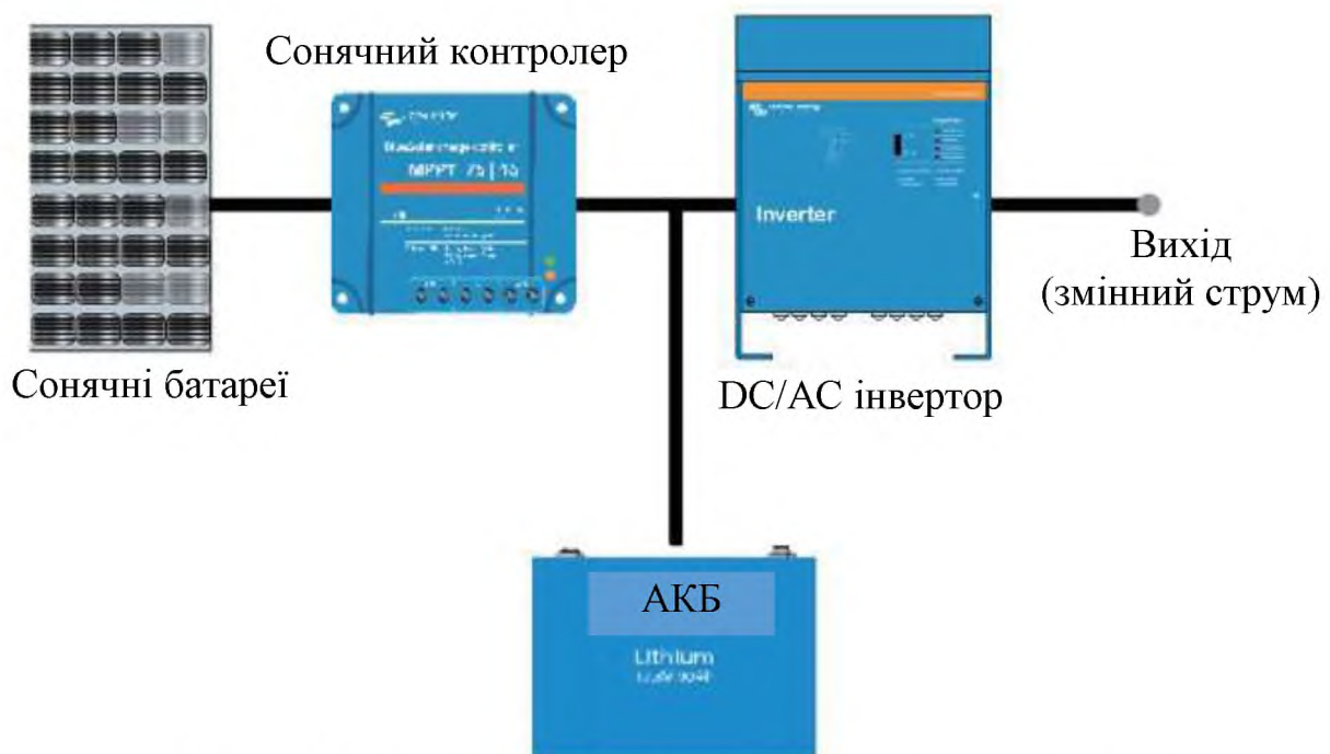
Рисунок 2 – Схема СЕС автономного типу змінного струму
