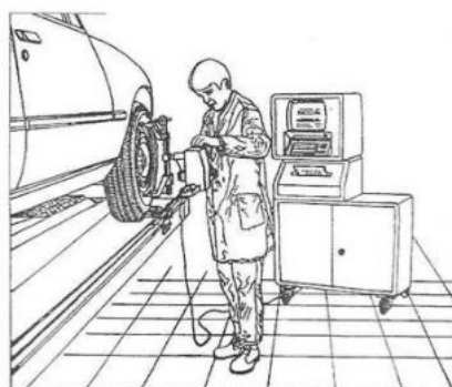
Рис. 12.7. Стенд для проверки правильности установки колес фирмы HOFMANN, модель DYNALINER 288
