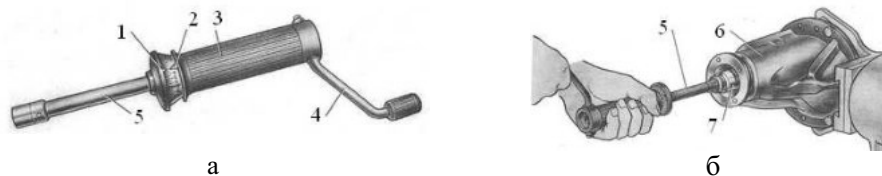
Рис. 4.30. Динамометр (а) и определение предварительного натяга подшипников (б):
