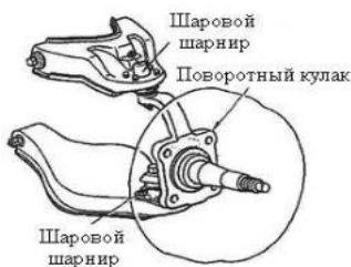
Рис. 5.18. Шаровые шарниры автомобилей «Тойота»:
