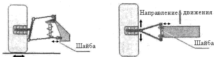
Рис. 6.38. Схемы регулирования углов установки колес с помощью шайб
