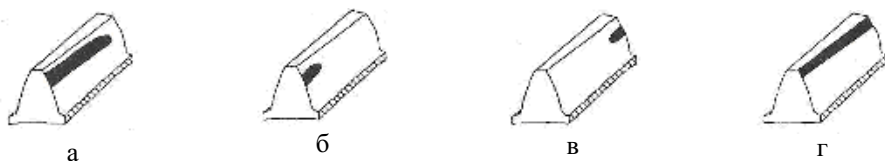
Рис. 4.18. Контроль с помощью краски зацепления зубцов конической передачи после испытания без нагрузки:
