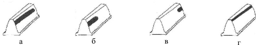
Рис. 4.19. Контроль зацепления под нагрузкой с помощью краски:
