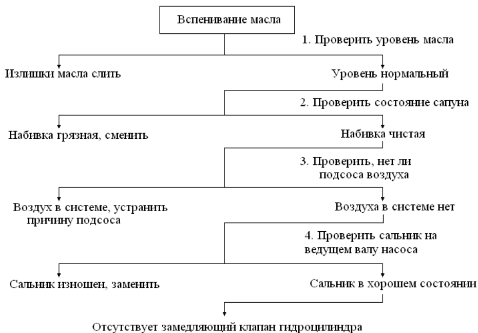
Рис.10.5. Поисковая система повреждений гидросистем
