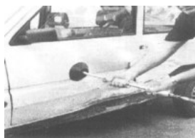
Рис. 9.16. Вакуумная рихтовка кузова рихтовочной пневмоприсоской
