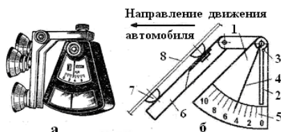
Рис. 3.10. Деселерометр мод. 1155 (а) и схема механического деселерометра (б):
