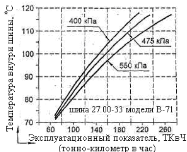
Рис. 6.10. Влияние внутреннего давления воздуха на срок службы шины (а) и на температуру внутри шины грузовых автомобилей (б)
