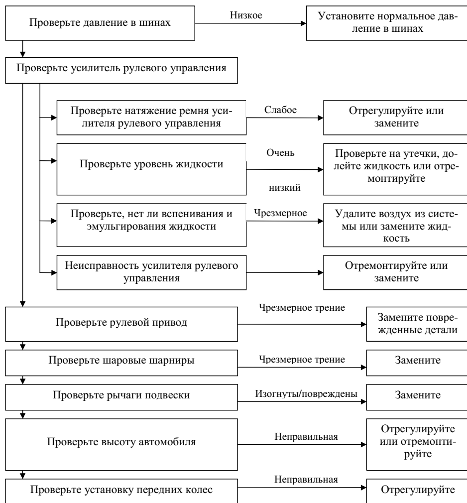
Рис. 5.12. Возможные причины тугого вращения рулевого колеса (для рулевого управления с усилителем)
