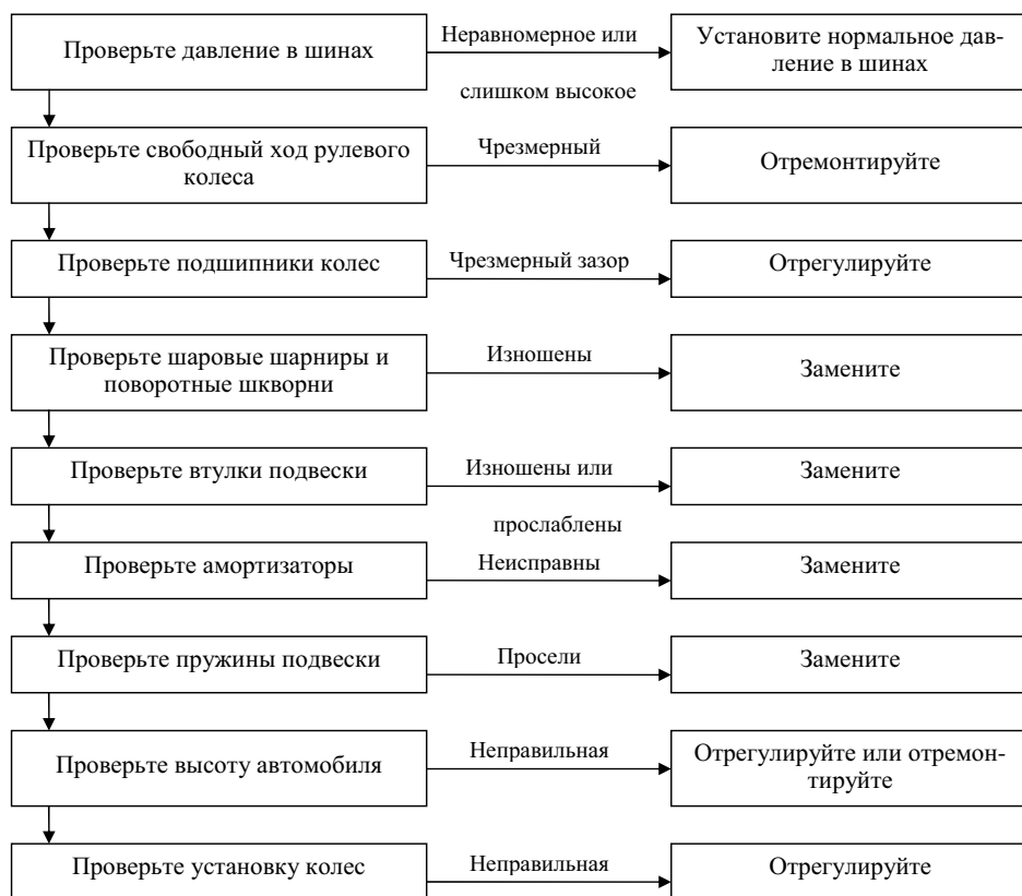
Рис. 5.11. Возможные причины обратного удара рулевого колеса
