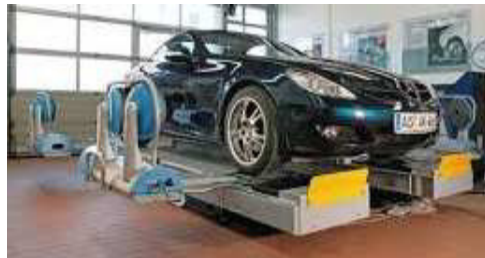
Рис. 6.22. Измерительные головки станда легко монтируются на традиционной площадке
