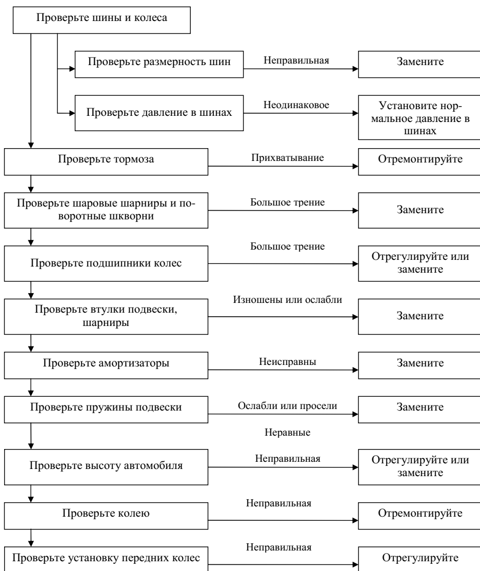
Рис. 5.9. Возможные причины увода автомобиля в одну сторону
