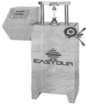
Рис. 7.28. Стенд для контроля пружин (виброизоляторов)
