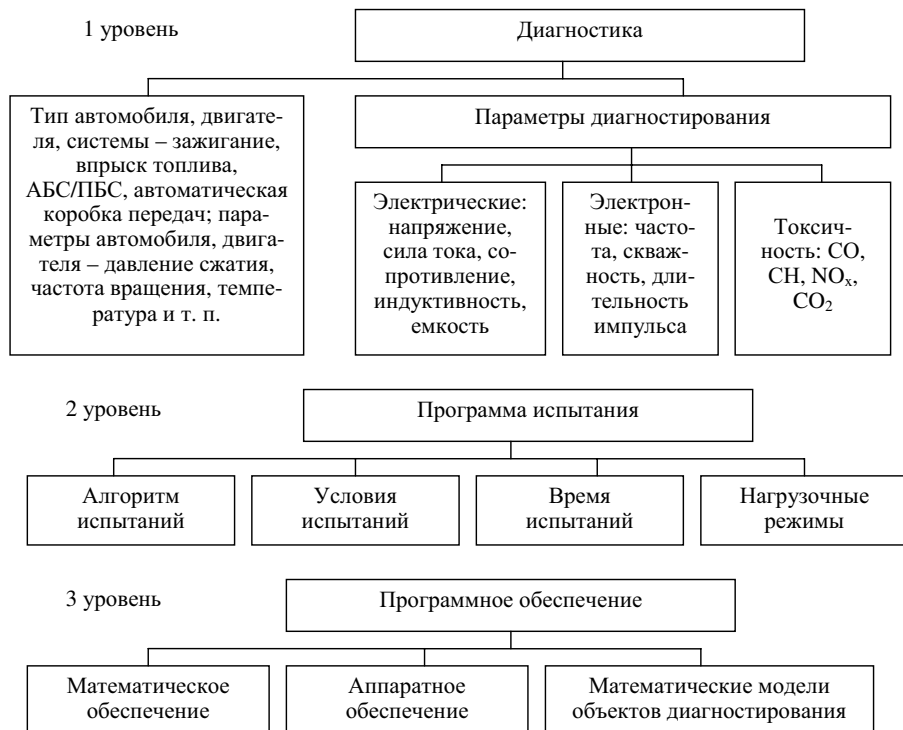
Рис. 2.11. Структура управления и программного обеспечения мотор-тестера
