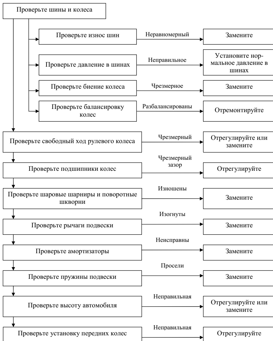
Рис. 5.10. Возможные причины углового колебания передних колес
