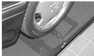
Рис. 6.19. Стенд для диагностирования углов установки управляемых колес
