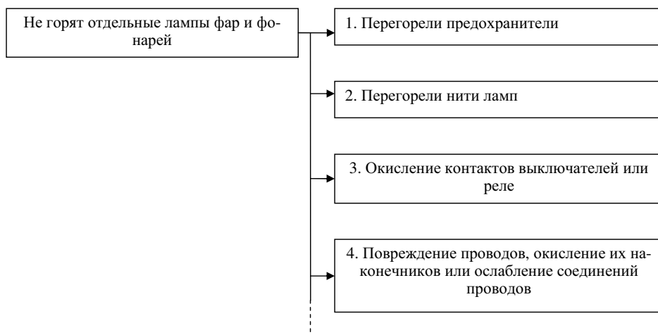
Рис. 8.2. Возможные неисправности освещения и световой сигнализации и их причины
