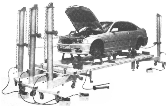
Рис. 9.26. Рихтовочный стенд «Сивер С»
