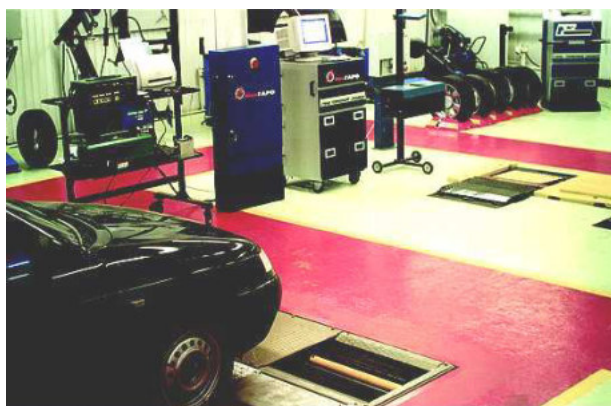
Рис. 12.2. ЛТК-ЗЛ-СП-11 – линия контроля технического состояния
