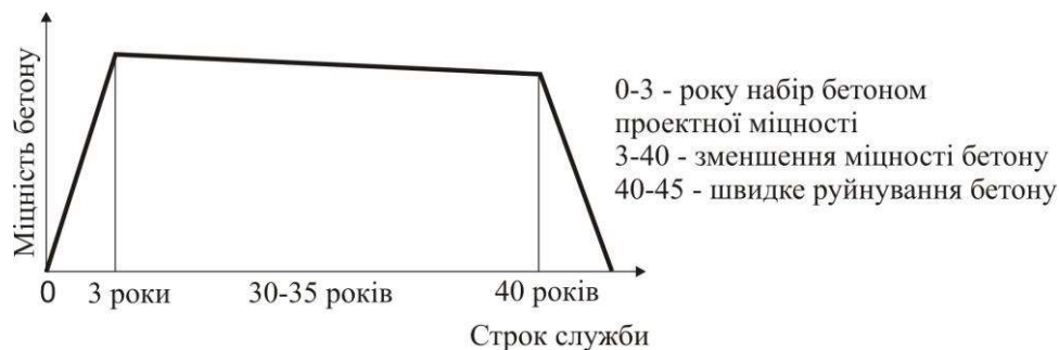
Рисунок 1 – Схема життя бетонної конструкції
