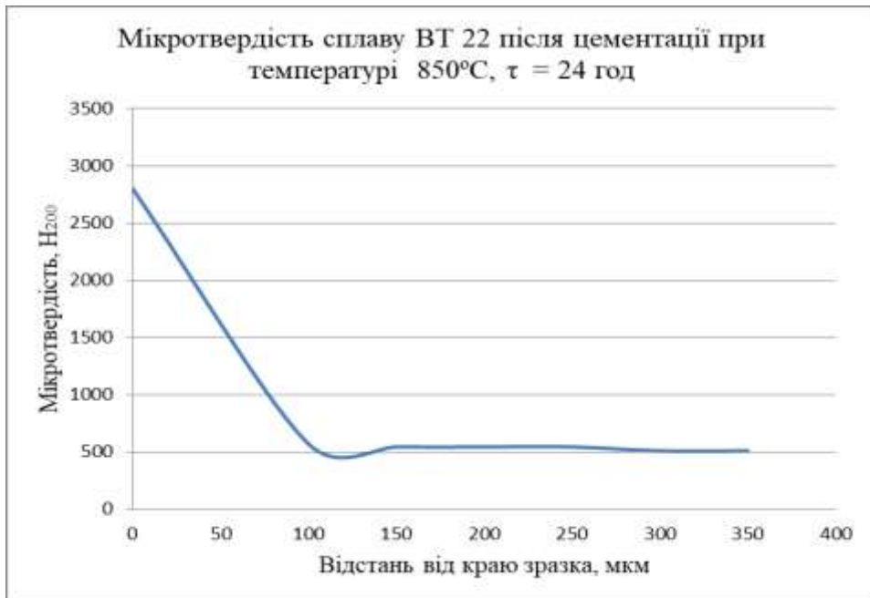
Рисунок 3.2 – Мікротвердість сплаву ВТ22 після цементації при температурі 850 °С, \tau = 24 год
