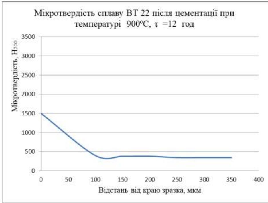
Рисунок 3.5 – Мікротвердість сплаву ВТ22 після цементації при температурі 900 °С, \tau = 12 год
