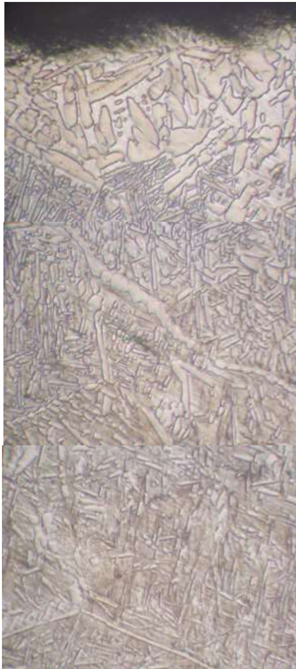
Рисунок 3.33 – Мікроструктура сплаву VT22 після цементації при температурі 950 °С, \tau = 36 год, \times 500
