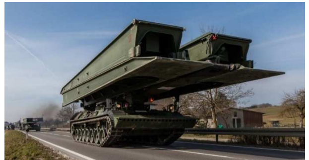
Рисунок 14 - Німецькі мостокладальні машини Viber на базі танку Leopard 1, що надано для потреб ЗСУ
