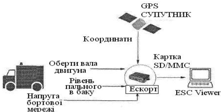
Рисунок 1 – Інформаційно-аналітична схема дистанційного контролю технічного стану
