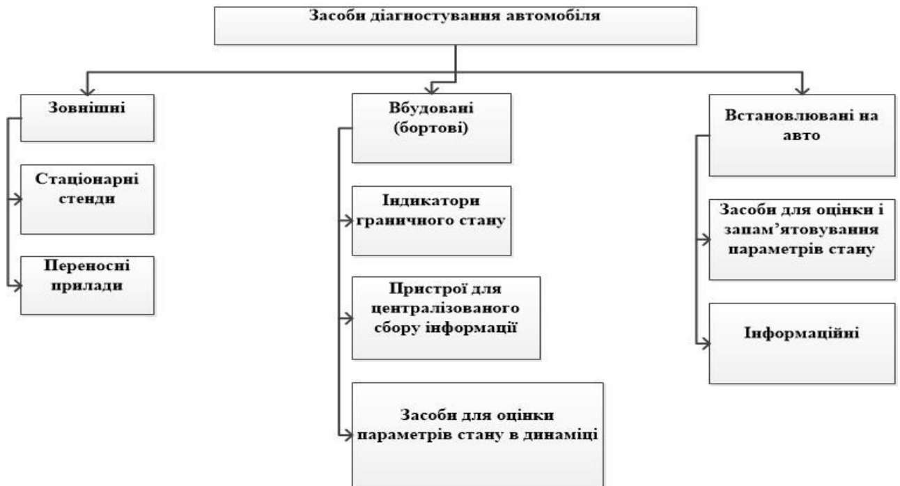
Рисунок 2 – Класифікація засобів діагностування по технологічному розташуванню
