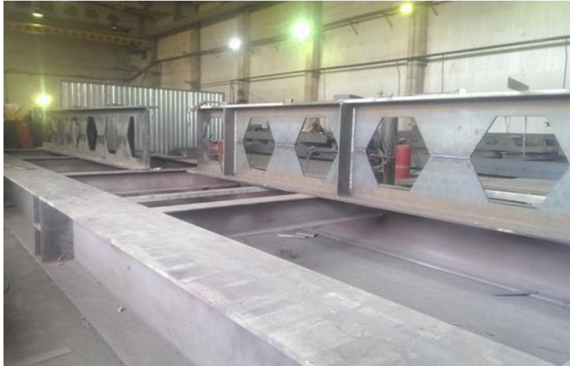
Рисунок 1 – Загальний вигляд балки з перфорованою стінкою
