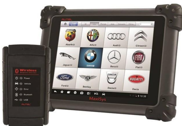
Рисунок 3 – Універсальне мультимарочне обладнання для діагностики автомобілів AUDI, Volkswagen
