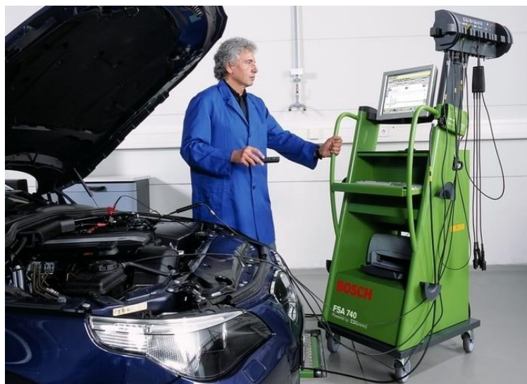
Рисунок 1 – Підключення цифрового сканера до автомобіля
