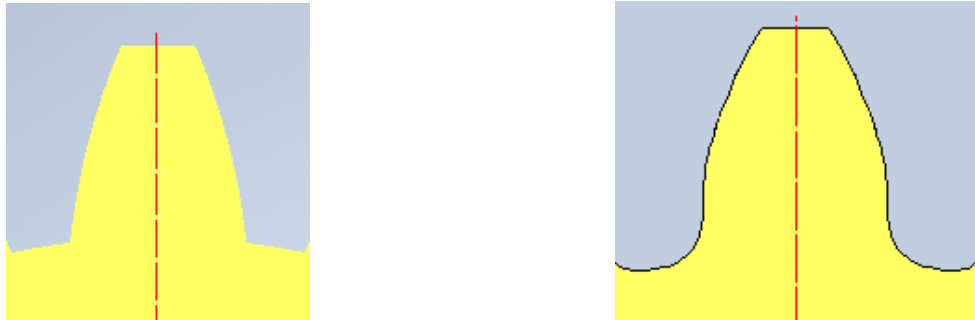
а) спрощене відображення зубця б) точна геометрія профілю
