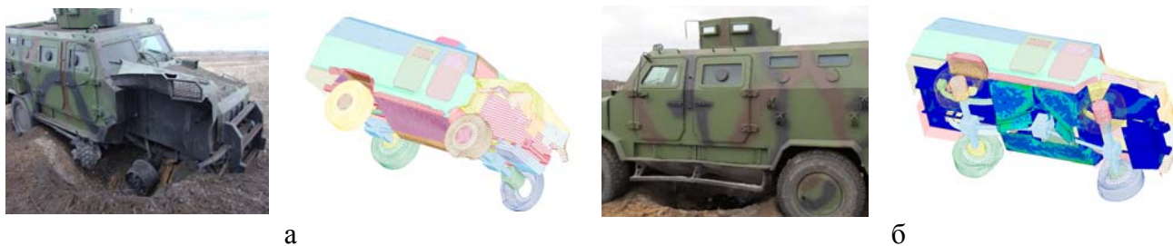
Рис. 2. Підрив БТА «КОЗАК-2»: а – під колесом; б – під днищем (праворуч – натурний експеримент, ліворуч – числовий експеримент)
