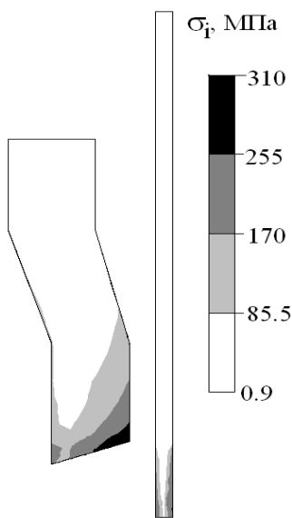
Рис.4. Распределение интенсивности напряжений в индукторе и заготовке
