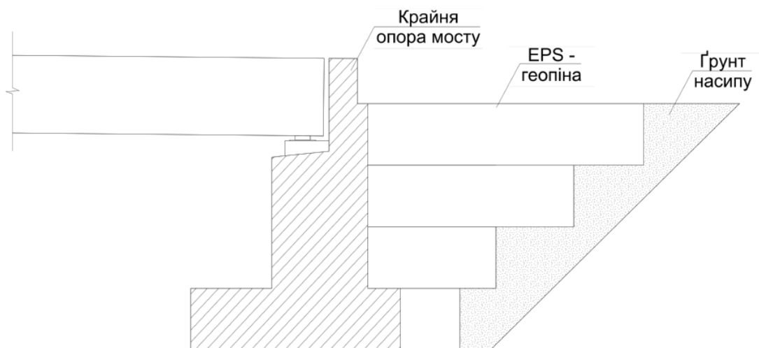
Рис. 2. Блоки EPS в тілі насипу підходу
