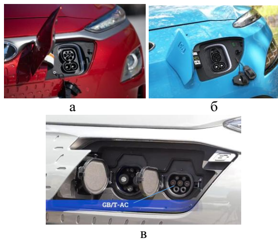
Рис. 4 – Зарядні порти Hyundai Kona Electric: а – CCS2; б – CCS1; в – GB/T
