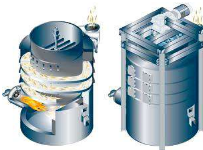
Рис. 2.2. Влаштування варильних котлов
