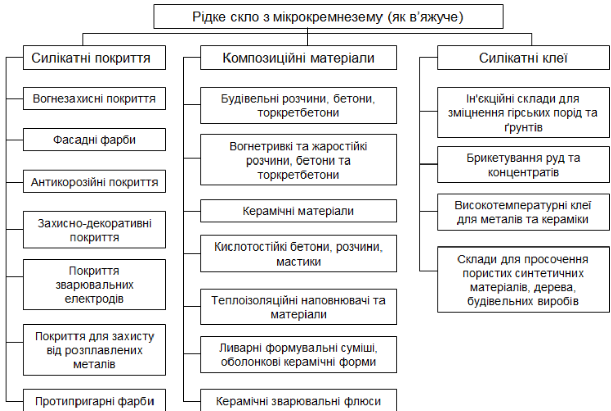
Рис. 7.9. Застосування рідкого скла як самостійного повітряного в'язучого у складі композиційних матеріалів, силікатних клеїв та силікатних покриттів
