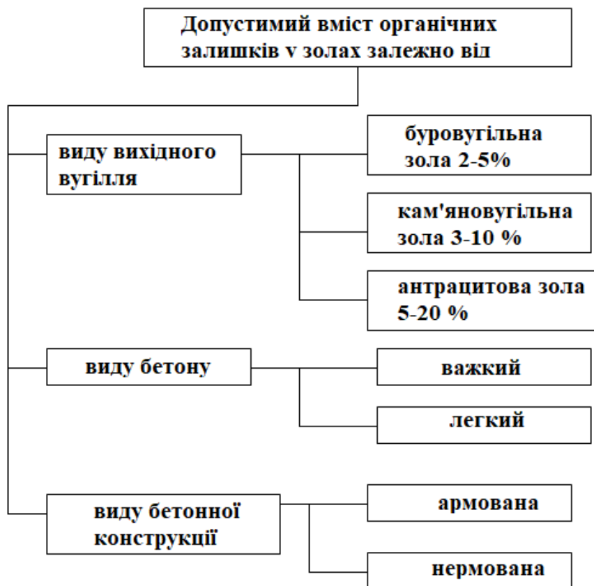
Рис. 5.16. Допустимий вміст органічних залишків у золах залежно від виду вихідного вугілля та напрямки його використання
