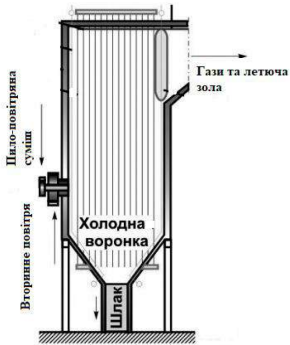
Рис. 5.3. Влаштування топки пілоподібного спалювання попередньо подрібненої сировини у зваженому стані
