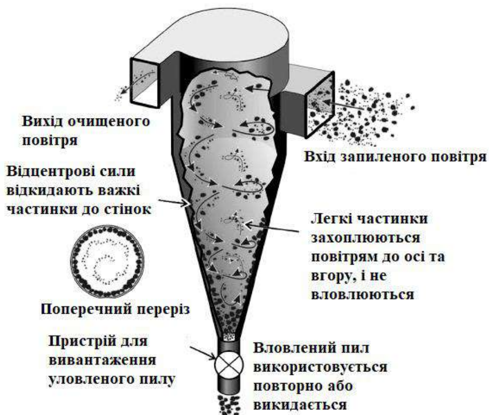
Рис. 5.4. Влаштування циклону
