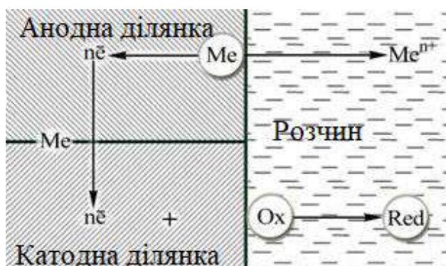
Рис. 8.21. Утворення на поверхні металу мікрогальванічного елемента
