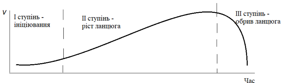
Рис. 4.6. Залежність швидкості розгалуженої ланцюгової реакції від часу
