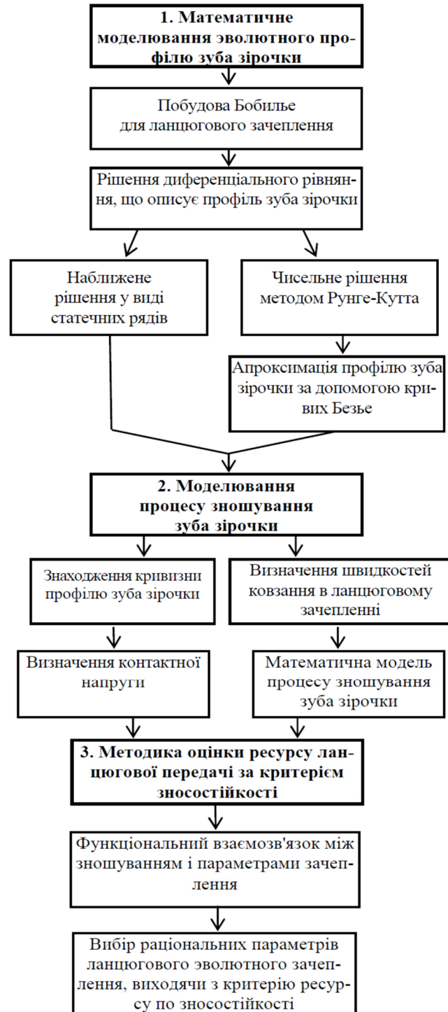
Рис. 4.9. Алгоритм методики аналізу ланцюгової передачі за критерієм зносостійкості профілю зуба
