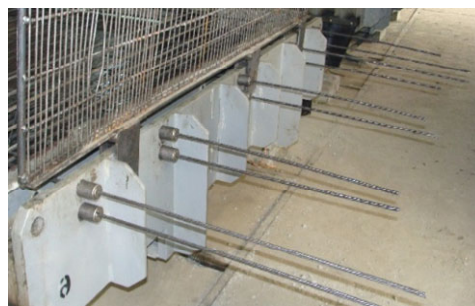
Рис. 6.1. Особливості конструкції плити ПДН-14
