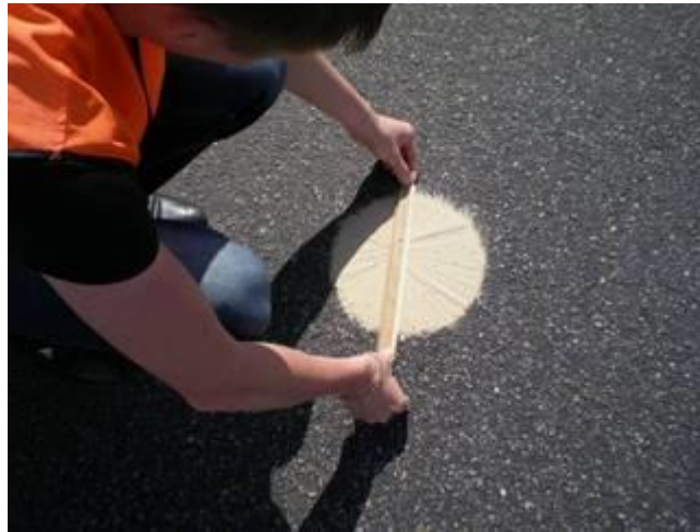
Рисунок 1 – Вимірювання шорсткості покриття методом піщаної плями
