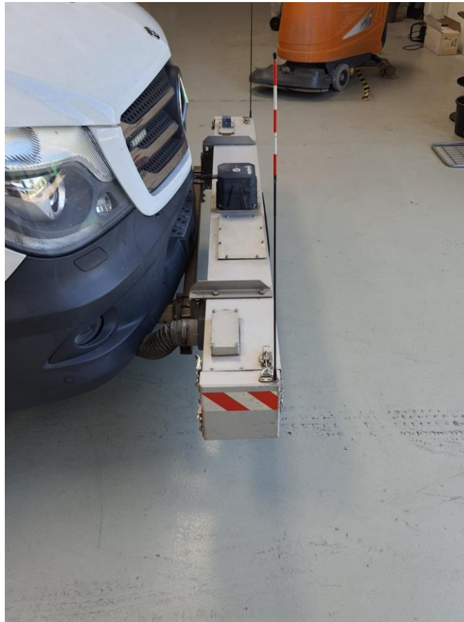
Рисунок 4 – Система фірми Dunatest для вимірювання рівності і шорсткості дорожніх покриттів
