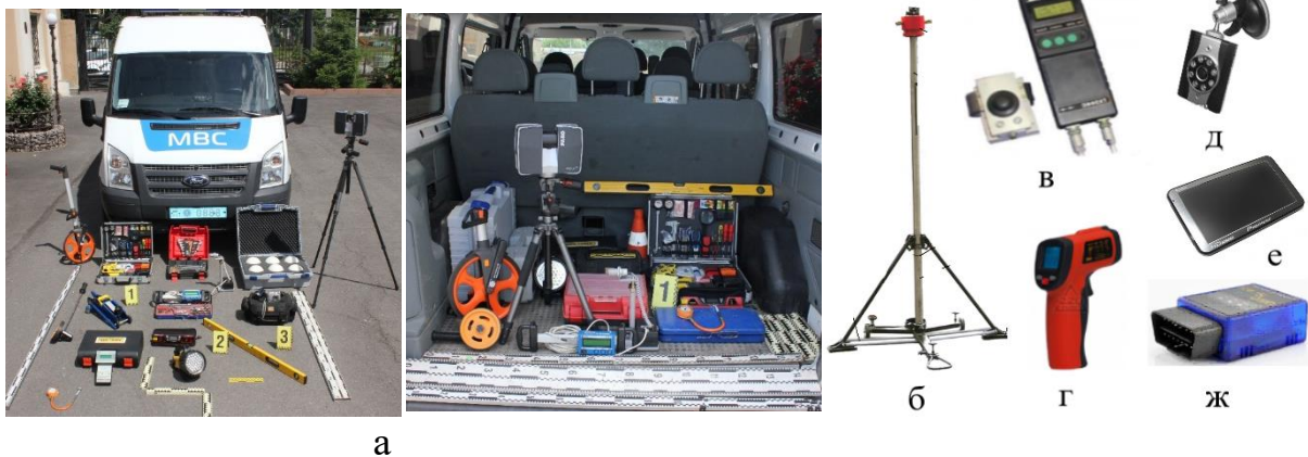
а – автомобіль експертної служби MBC України зі штатним обладнанням: лазерний сканер FARO, вимірювач відстані MD-21E, прилад AMX-520, масштабні лінійки, номерки, рулетки, рідинний рівень, комплект інструменту, цифрові фотоапарат та відеокамера; б – прилад для виміру коефіцієнту зчеплення; в - Прилад «Ефект»; г – пірометр; д - відеореєстратор Globex; е – JPRS-навігатор Pioneer; ж – OBD-сканер
