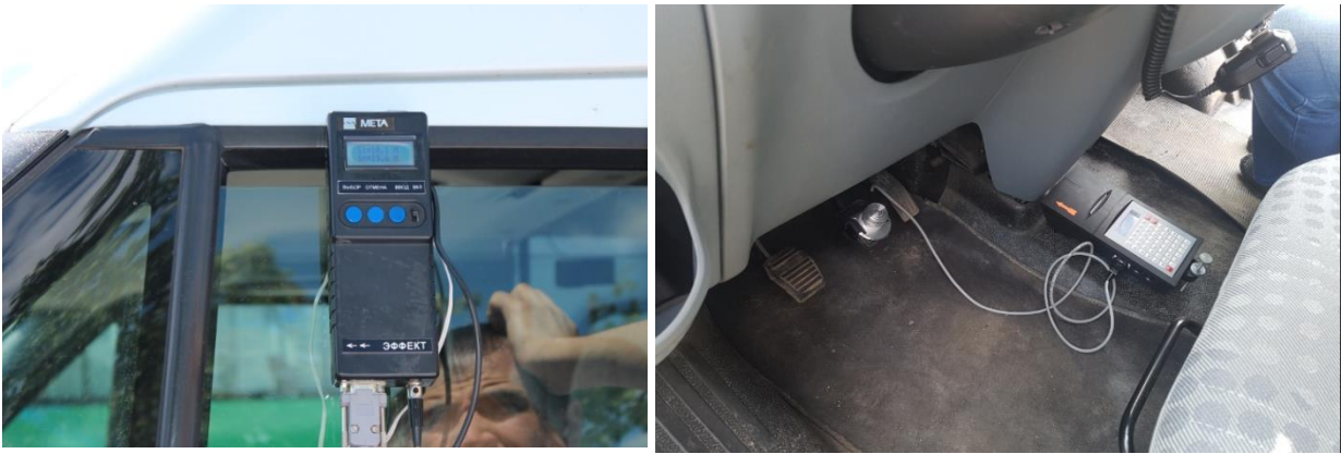
а – вертикального типу (кріпиться на скло) прилад «Ефект»; б – горизонтального типу (фіксується на підлозі) прилади VZM-300 або AMX-520
