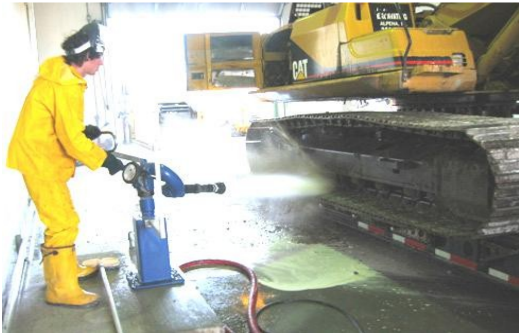
Рис. 20.3 – Миття ходової частини екскаватора Caterpillar
