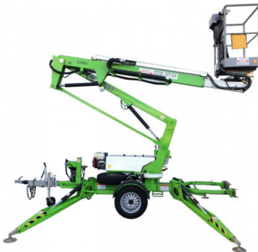
Рисунок 7 Мобільний підйомник на причепі до легкового автомобіля
