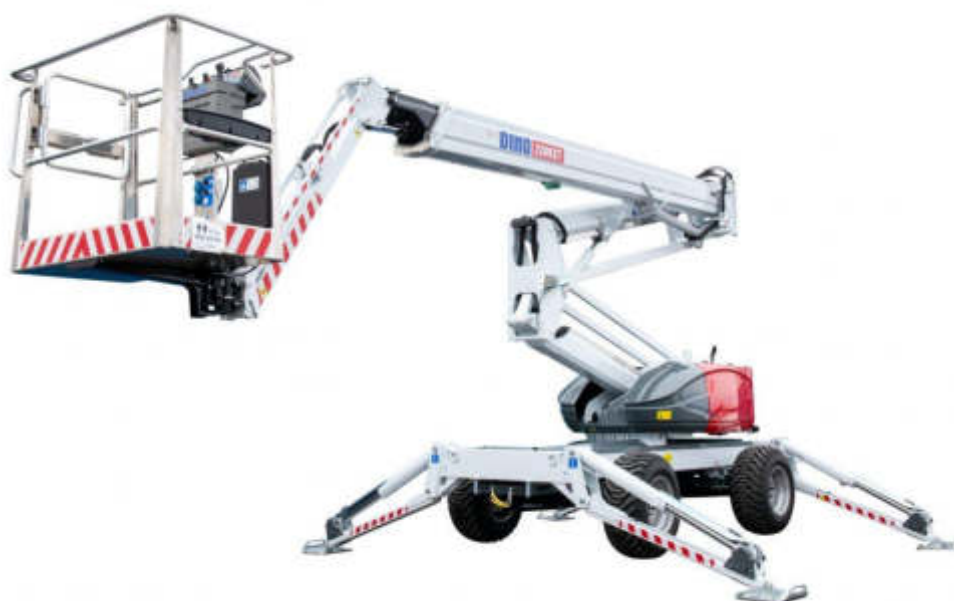
Рисунок 5 Колісний самохідний підйомник з аутригерами
