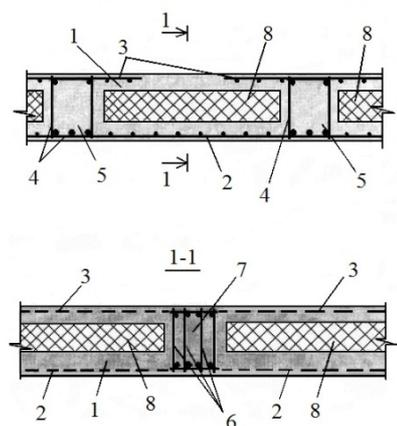
Рис. 3. Конструкция облегченного железобетонного перекрытия с формой вкладыша параллелепипед: 1 – балочная плита; 2, 3 – арматура нижней и верхней сеток; 4 – арматурный каркас второстепенной балки; 5 – второстепенная балка; 6 – арматурный каркас главной балки; 7 – главная балка; 8 – вкладыш
