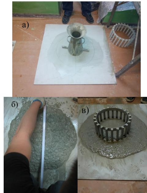
Рис. 11. Проведение испытаний самоуплотняющейся бетонной смеси для определения удобоукладываемости: а – приборы для испытания; б – измерение диаметра расплыва конуса; в – распływ бетонной смеси через блокировочное кольцо
