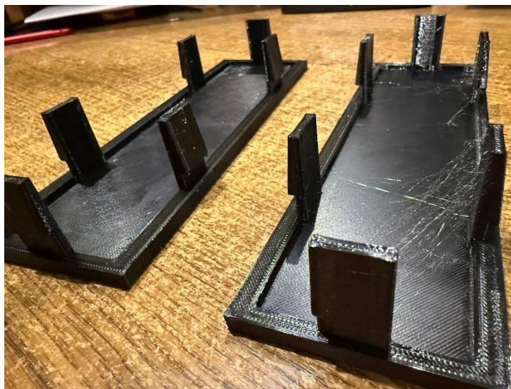
Рис. 10. Надруковані моделі з використанням Pressure Advance (зліва) та без нього (праворуч)
