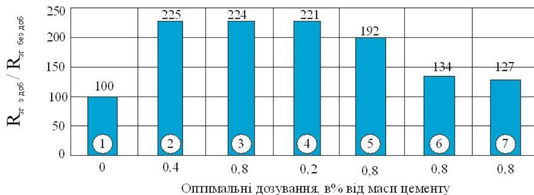
Оптимальні дозування, в% від маси цементу 1 - без добавок; 2 - АГ; 3 - С-3; 4 - ПВА; 5 - МС; 6 - ПТО; 7 - КМЦ Рисунок 5 – Ефективність добавок при оптимальних дозуваннях
