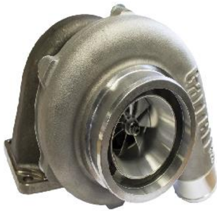
Рисунок 2 – Фотографія та характеристика турбокомпресору Garrett GTX3071R Gen II [5]
