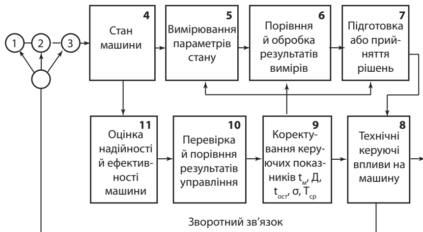
Рис. 9.7. Схема управління технічним станом машини
