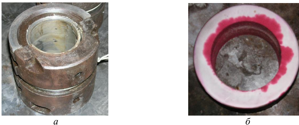
Рисунок 2 – Неякісна заливка бабітового шару ПК (а) і перевірка якості адгезії антифрикційного шару методом кольорової дефектоскопії (б).
