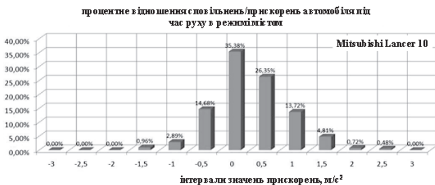
Рисунок 5.21. Гістограми розподілу прискорень автомобіля Mitsubishi Lancer 10, що одержані після обробки результатів експериментів
