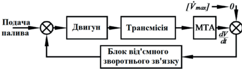
Рисунок 1.2. Блок-схема системи автоматичного регулювання синхронного руху комбайна і МТА
