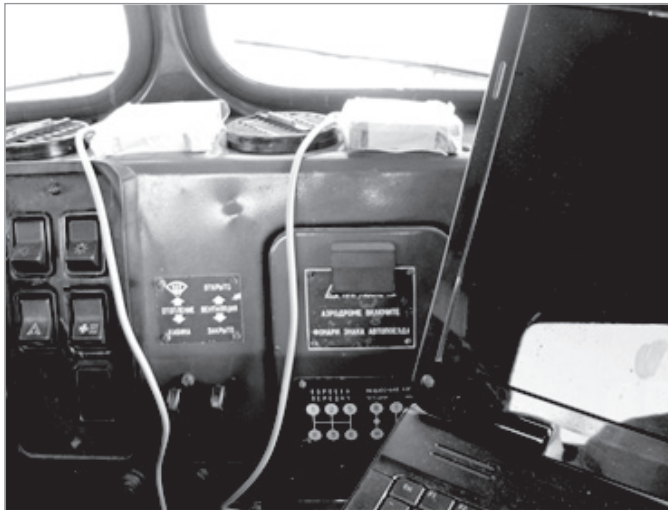
Рисунок 5.9. Установка датчиків прискорень на колісні машини: а) ХТЗ-17221 з причепом 2ПН-9; б) АПА-50М
