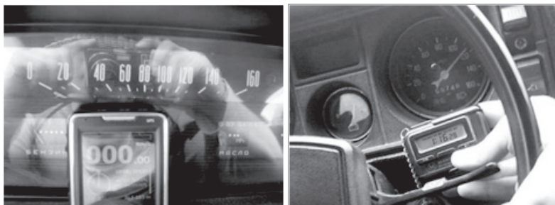
Рисунок 5.7. Реєстрація швидкості автомобіля за допомогою спідометра, GPS і часу руху за допомогою секундоміра
