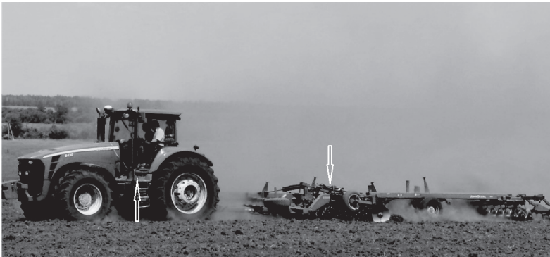
Рисунок 5.82. Загальний вигляд ґрунтообробного агрегату John Deere-8430 + John Deere 637 (стрілкою вказані місця розташування датчиків)
