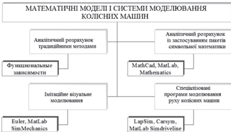
Рисунок 5.45. Основні групи математичних моделей колісних машин та систем моделювання
