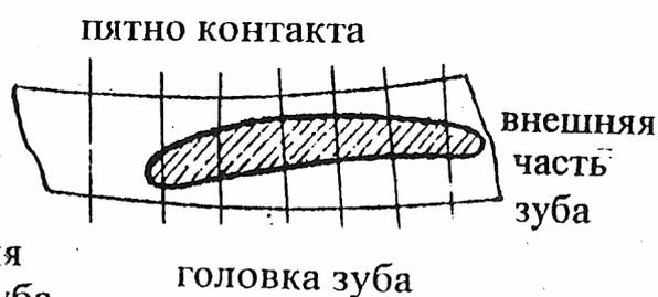
Рисунок 1 – Схема разделения моделей на срезы и расположения контакта
