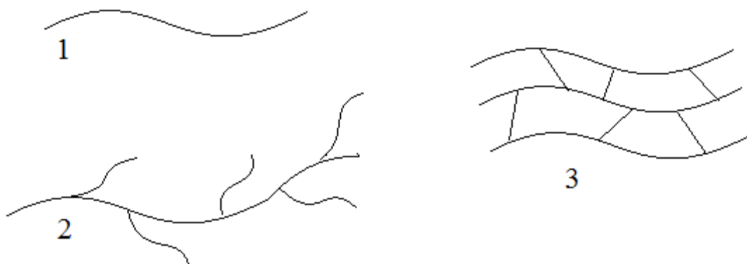
Рис. 15.1. Схематичне зображення будови полімерів: 1 – лінійних; 2 – розгалужених; 3 – сітчастих
