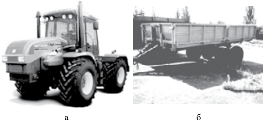
Рис. 3.11. Загальний вид трактора ХТЗ-17221 і причепа 1-ПТС9: а – трактор ХТЗ-17221; б – причеп 1-ПТС9
